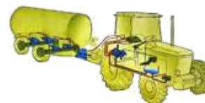
Маслопогружные тормоза ('мокрые тормоза')
